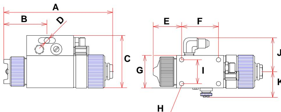
Fixação da pistola na base : 4 parafusos M 6 x 50.
