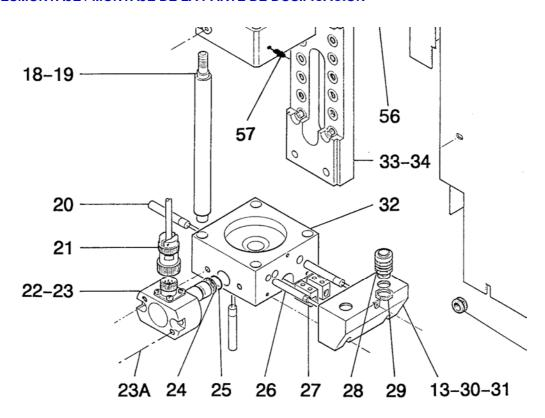
Desmontar la válvula de entrada y la válvula de salida del dosificador.
