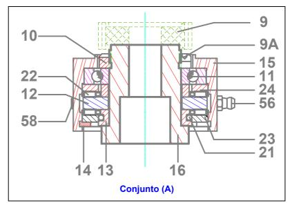
Cambiar el conjunto (A). Volver a montar el piñon receptor (9), los pasadores (8), la arandela (28) y los 2 tornillos (29).
