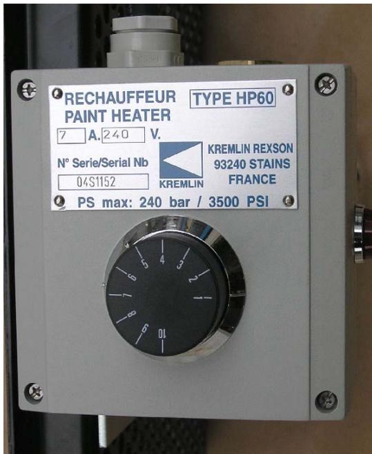
Installieren Sie eine Steckdose am Ende des Kabels (2 Klemmen + Erde).
