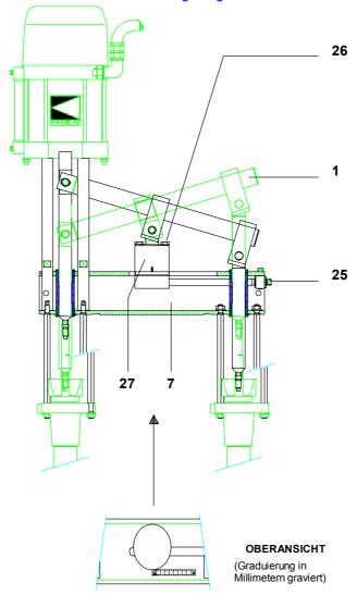
Den Pumpenmotor mit Luft versorgen (Stellglocke "Motorluft") und Hebearm (1) in <u>waagerechte</u> Lage bringen.
