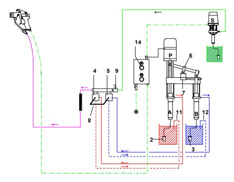
Der Kolben des BASIS-Hydraulikteils (A) ist mit dem Luftmotor (P) fest verbunden.
