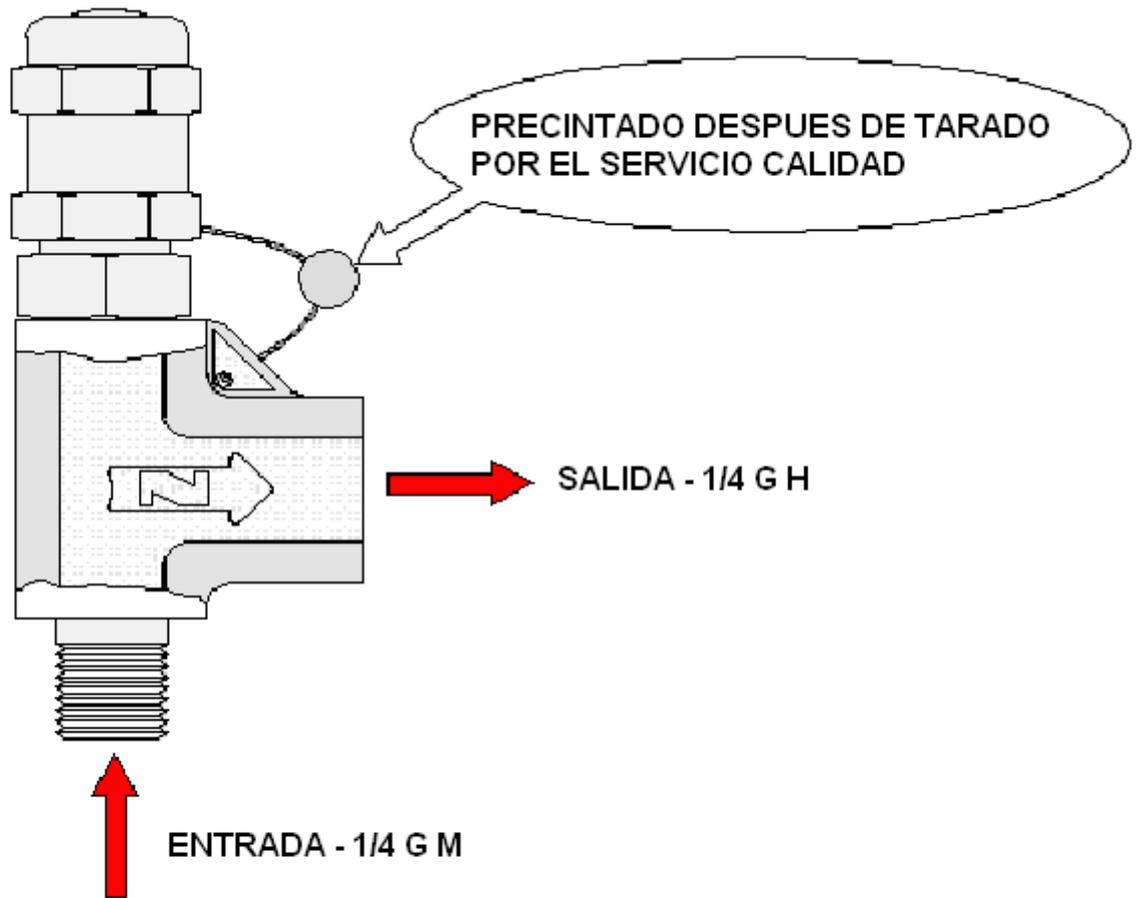
REFERENCIA DEL MUELLE PARA VÁLVULA DE SEGURIDAD
