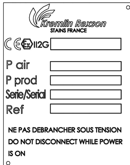
Typenschild des Materialschranks (Montage des Schrankes innerhalb der Spritzkabine → Kennzeichnung nach ATEX Richtlinie)
