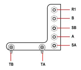
Raccorder le pistolet sur les 2 sorties situées sur la platine à gauche (alimentation en air et en produit).
